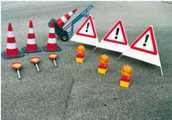
*Bild 10 Gerätesatz Verkehrsabsicherung Autobahn*
