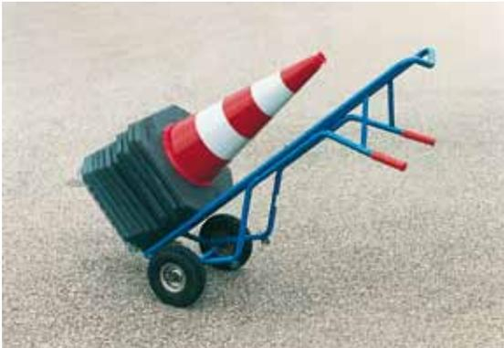
*Bild 7 Transportkarren mit Zapfen für den Transport von 10 Leitkegeln*
