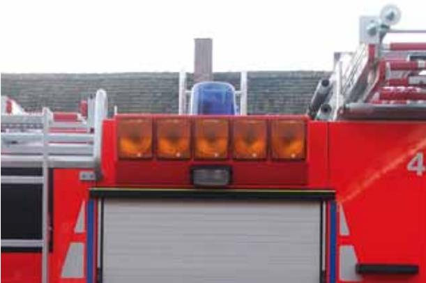
*Bild 12 Heck-Warnsystem nach Anlage 4*
